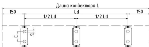
Схема крепления к полу
