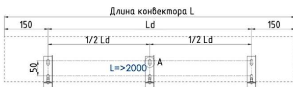
Схема крепления к стене
